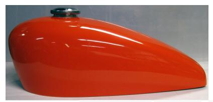
指示力ルイボーンKR/スプリントタンクタンク底に2つの1/4-20取り付けスタッドを取り付けました。1つのペアはKRと並び、もう1つのペアはH-Dスプリント用です。マウントホールの広がりに合わせて、マウントバーの穴を微調整する必要がある場合があります。タンクとバックボーンの間に発泡ゴムを使用してください。これは、タンクをフレームから強制的に遠ざけるためのスプリングのように機能します。前後に異なるレベルのフォームでタンクを水平にすることができます。
