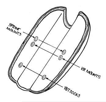
ペットコック私が取り付けたペットコックはグラスファイバーに直接ねじ込まれ、5分間のエポキシで密封されます。このシーリング技術は何年もの間うまく機能してきました。取り外すには、大きな三日月レンチをそれらに置き、緩めるだけです。タンクを引き裂いているように聞こえるかもしれませんが、そうではありません。再インストールするには、ペットコックスレッド全体に5分間のエポキシを再塗布し、締めます。(燃料通路の穴には何も入らないでください。糸によって現れるエポキシの小さなビーズを拭き取らないでください。これは接合部を密封し、強度を追加します。5分と書かれていても、数時間待って治療してください。2トンのエポキシは絶対に使用しないでください、さもなければあなたはペットコックを取り除こうとしてあなたのタンクを破壊するでしょう。
